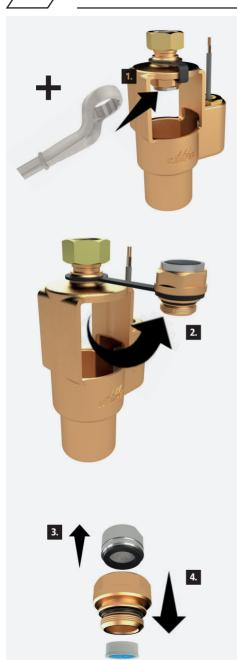
1. Schrauben Sie mit einem 27-er Ringschlüssel das Rotguss-Einschraubteil mit dem DMB ab.
