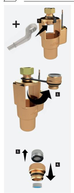
1. Svitare la parte avvitata in bronzo rosso assieme al DBM utilizzando una chiave ad anello da 27 mm.
